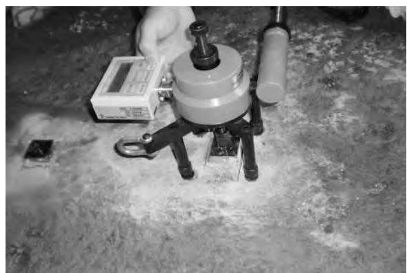
写真-5 建研式引張試験
